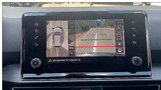
Una pantalla central muestra las imágenes de la cámara trasera. F. C.
